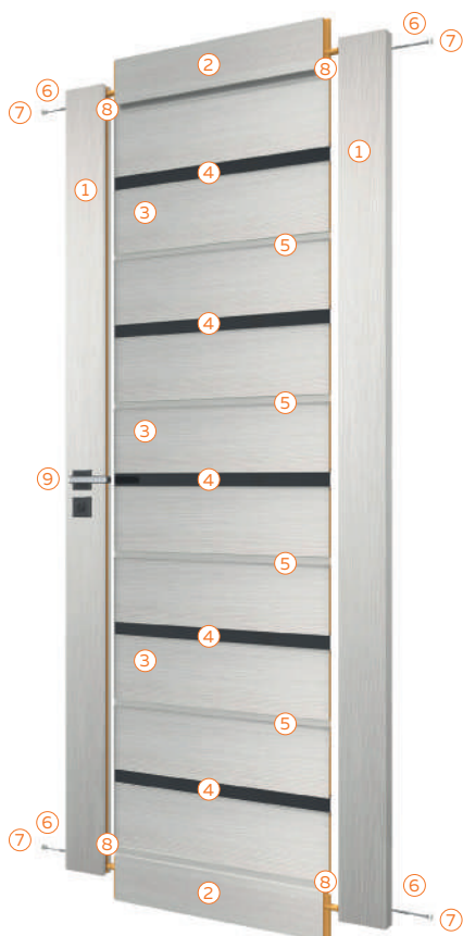
Схема конструкции на примере DUPLEX Construction diagram on the example of DUPLEX
