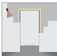
**5.** Закрепить короб в дверном проеме к стене при помощи шурупов и монтажной пластины, одним концом предварительно закрепленной на коробе.
