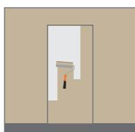
**8.** Выровнять при помощи шпательки плоскость стены и дверной коробки. Нанести декоративное покрытие (краска, обои, декоративная штукатурка), предварительно подготовив поверхность.
