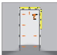
**3.** Закрепить монтажные пластины при помощи шурупов к тыльной стороне короба.
