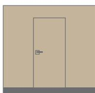
**9.** Петли вкрутить сперва в полотно, затем произвести навеску полотна на короб и закрепить петли на коробе при помощи винтов, входящих в комплект фурнитуры.
