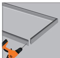
**2.** Стойки коробки поставляются торцованными с одной стороны под углом 45° и под углом 90° с другой. Поперечный брусок коробки торцован с двух сторон под углом 45°.
