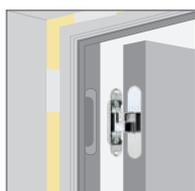
**7.** Заполнить монтажной пеной зазор между коробом и стеной. Произвести выдержку до полного отверждения. После высыхания пены аккуратно срезать излишки, не повредив короб. Приступить к финишной отделке.
